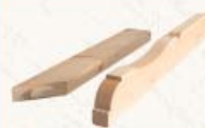
Więźba dachowa obrabiana na CNC
